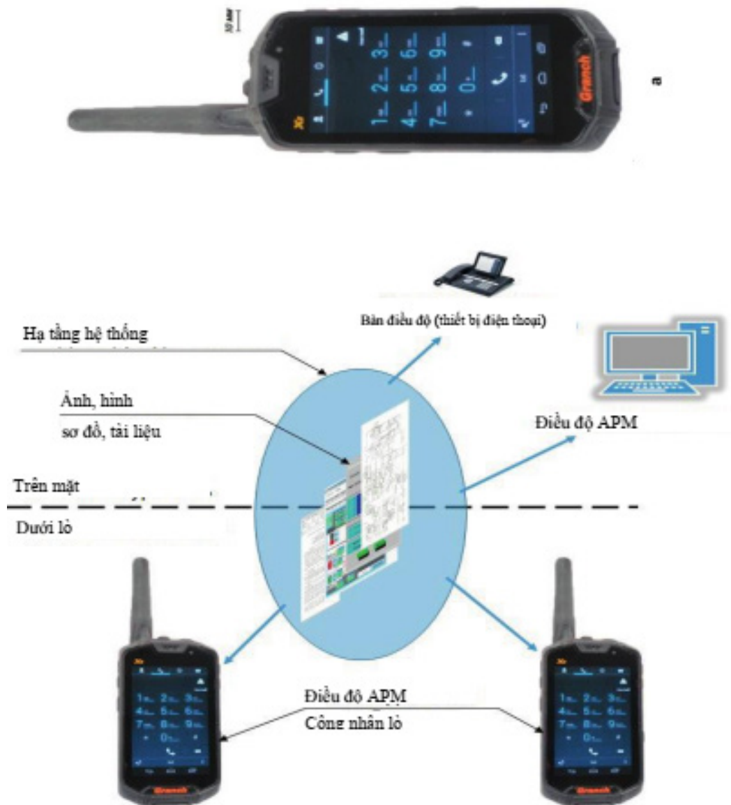
Hình 5 - Thiết bị liên lạc nội bộ: a) Tổng thể; b) Liên lạc di động giữa các thiết bị liên lạc nội bộ và với máy trạm của điều độ viên (bảng điều khiển từ xa) đến người nhận
